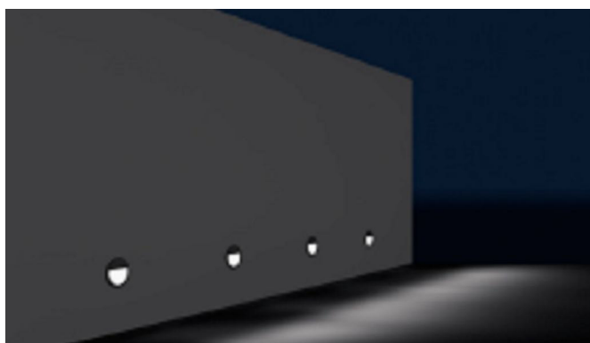
fig. III.1.1.3.2 – Esempio di illuminazione di orientamento realizzata con incassi a parete (fonte ERCO)
