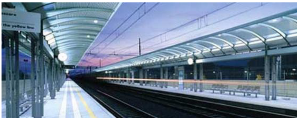
fig. III.1.2.3.2 – Immagine della pensilina della stazione di Rimini Fiera che adotta apparecchi illuminanti a LED posti in prossimità del bordo della pensilina per incrementare i livelli di illuminamento sulla striscia gialla di sicurezza e apparecchi a illuminazione diretta/indiretta per garantire un idoneo e più uniforme illuminamento medio sulla banchina (fonte Internet)
