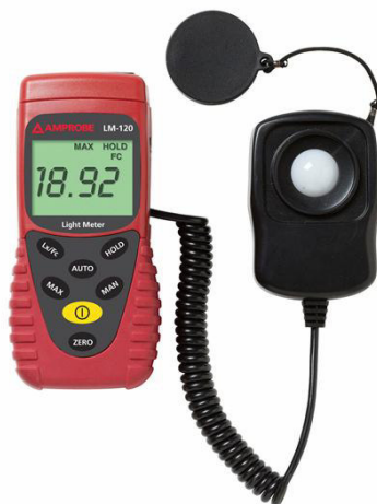
fig. II.4.1.1 – Esempio di luxmetro digitale (fabbricante Amprobe) con sensore separato in cui si nota la particolare forma convessa dello schermo diffondente in grado di raccogliere le radiazioni luminose incidenti con diverse angolazioni secondo la legge del coseno per ottimizzare la misurazione ed il relativo coperchio di protezione del sensore (fonte Internet)
