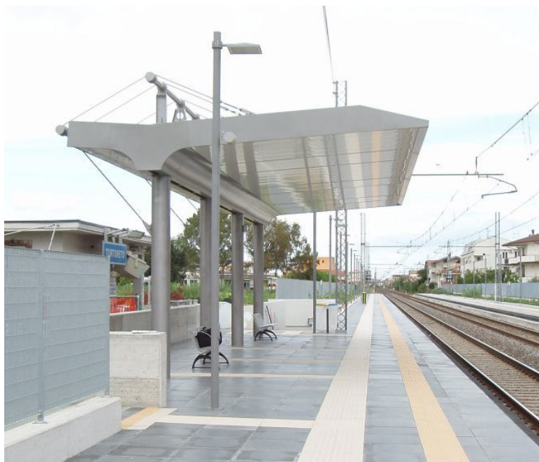
fig. III.1.2.3.1 – Immagine di un palo di altezza pari a 5,7 metri che monta ad una altezza di 5,5 metri da terra una armatura stagna con ottica stradale adatta ad aree urbane e pedonali e relativo apparecchio a LED da 48 W. L'interdistanza dei pali è di circa 13,00 metri. Questo tipo di apparecchio è impiegato per il tratto scoperto della banchina nella stazione di Tortoreto Lido appartenente alla linea Ancona-Foggia (fonte RFI)
