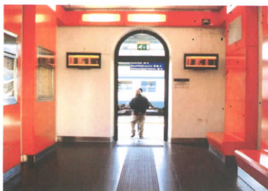
Stazione di Frattamaggiore-Grumo: pavimentazione in gres porcellanato 60x30)
