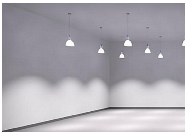
fig. III.1.3.3.6 – Illuminazione diretta orientata realizzata con apparecchi a sospensione nel caso in cui i soffitti risultino particolarmente alti (fonte ERCO)
