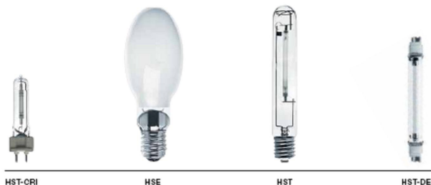
fig. II.3.2.6.1 – Tipologie indicative di lampade a vapori di sodio ad alta pressione. La lunghezza di una lampada a vapori di sodio ad alta pressione da 600 W (indicata con HST) può raggiungere i 30 cm con un diametro variabile da 5 a 12 cm (fonte Zumtobel Lighting)
